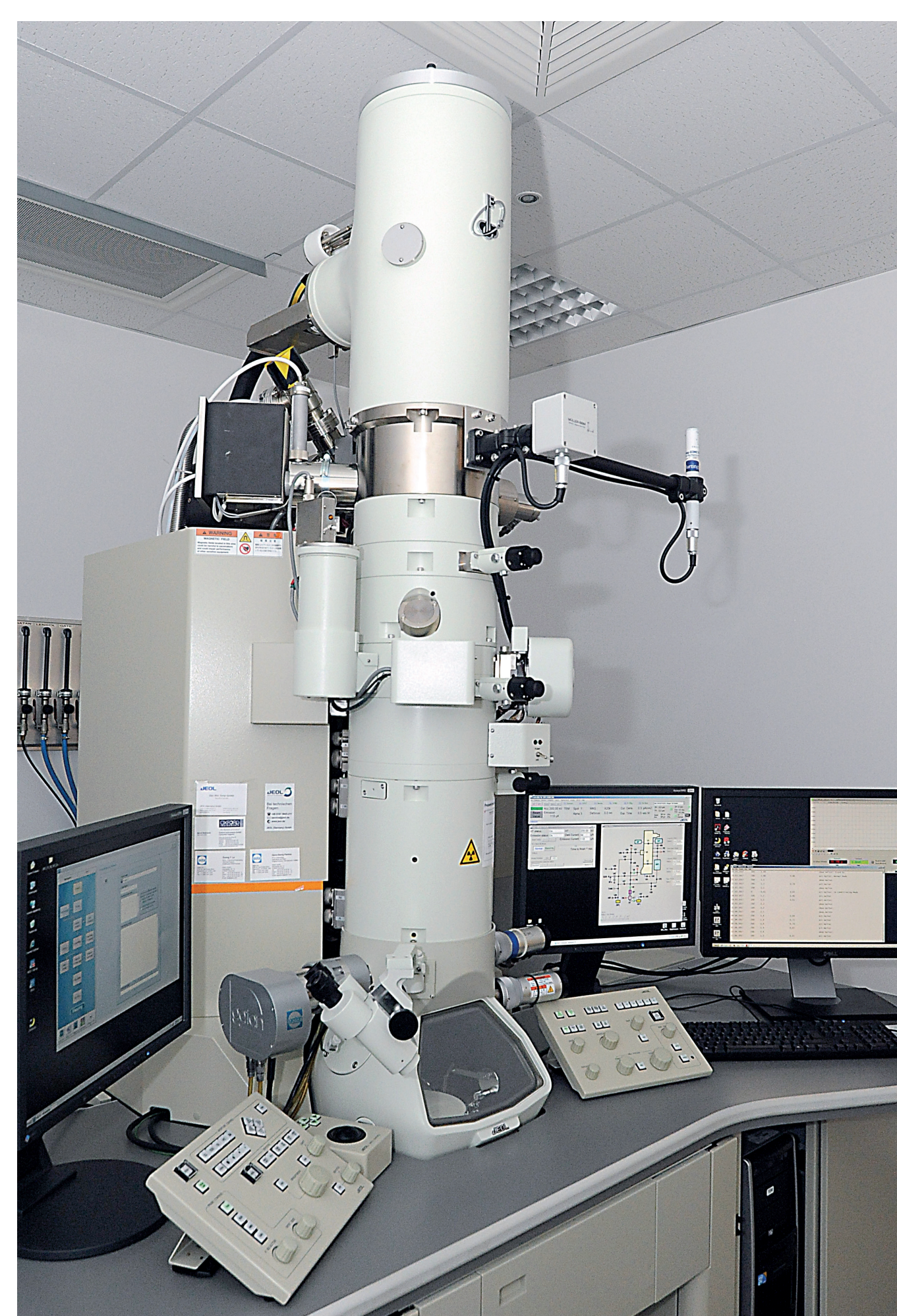
HR-TEM (Jeol 2100F) Beschleunigungsspannung: 80 kV - 200 kV Vergrößerung: 50 x - 1 500 000 x Auflösung Kristallgitter: 0,14 nm Bildpunkt: 0,23 nm Erweiterungsgeräte: EDX-System, Tomographie, 2 CCD-Kameras
