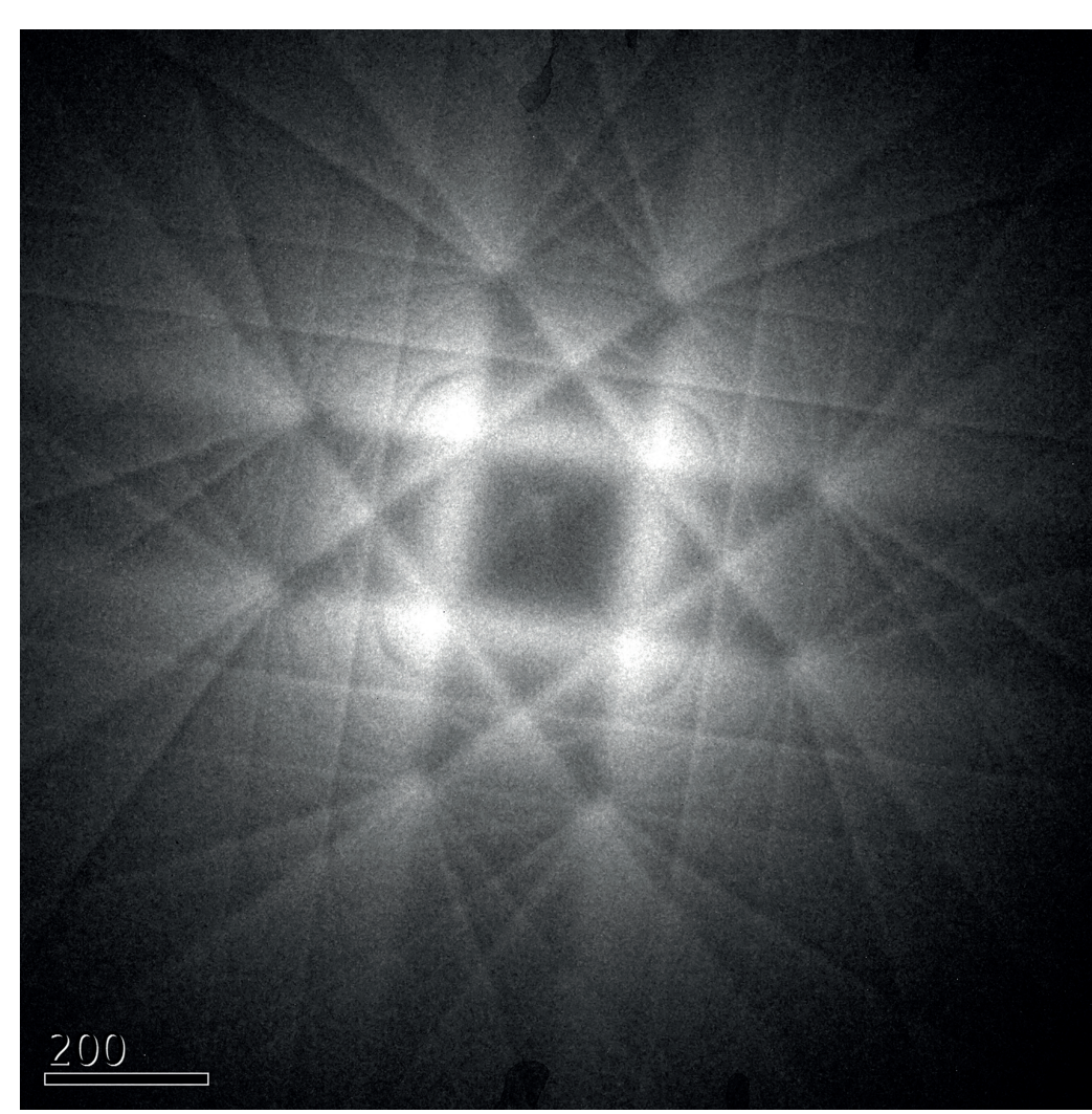
Beugungsbild von elastisch gestreuten Elektronen an einer mehrere Mikrometer dicken Siliziumschicht, HR-TEM (Jeol), Prof. Dr. Sascha Schäfer
